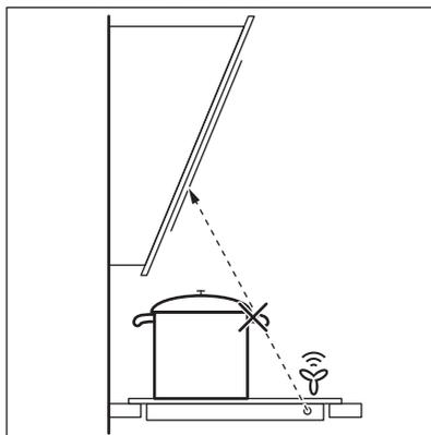
**i** Andere op afstand bediende apparaten kunnen het signaal hinderen. Gebruik geen op afstand bedienbare apparaten op het moment dat u de functie op de kookplaat gebruikt.
